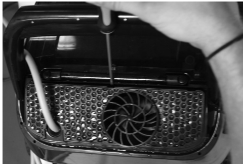
7.1. Använd en platt skruvmejsel för att ta bort skyddsgallret.
