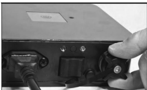
4.1 Skruva av locket bredvid strömbrytaren.
