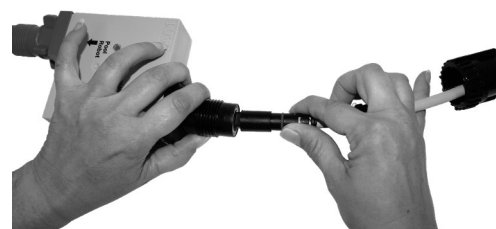
4.3 Sätt i änden av den flytande kabeln från transformatorn i "POWER"-uttaget. Var noga med åt vilket håll den ska sitta.
