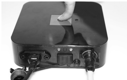
4.10 Tryck på on/off-knappen ovanför transformatorn för att starta roboten. En röd lampa tänds. När rengöringscykeln avslutas släcks den röda lampan.
