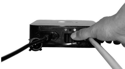
4.9 Tryck på brytaren på sidan av transformatorn för att starta den. En blå lampa tänds.
