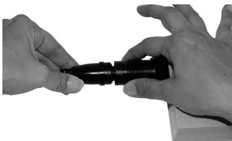
4.4 Dra höljet för att ansluta kontakten från den flytande rotationskopplingen.
